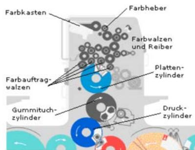
Druckwerk im Schnitt
