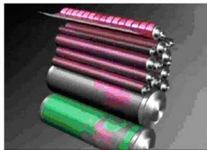
Farbwerk, Plattenzylinder und Gummituchzylinder
