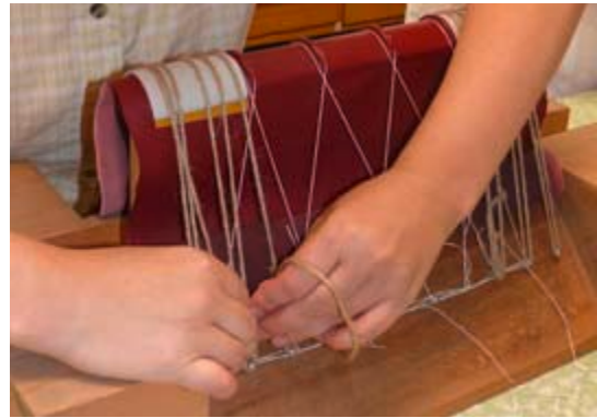
Abbinden des Rückens zur Vermeidung eines Sattelrückens an Kopf und Fuß
