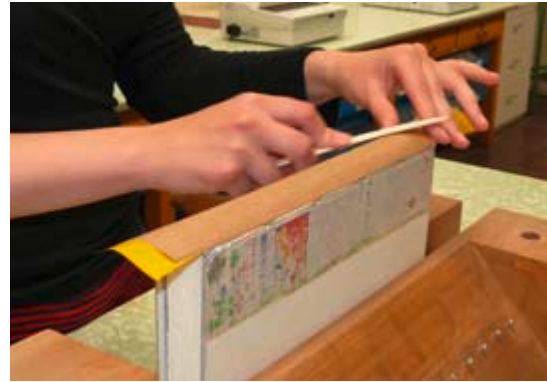
Anreiben der angeschmierten Hülse am Buchblock
