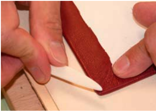
Begradigen der fertigen Lederecke mit dem Falzbein
