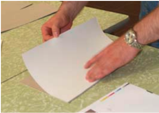
Kaschieren des Papiers für die Deckelpappe
