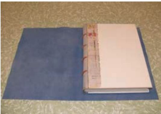
Positionierung des Buchblocks auf dem zurechtgeschnittenen Leder
