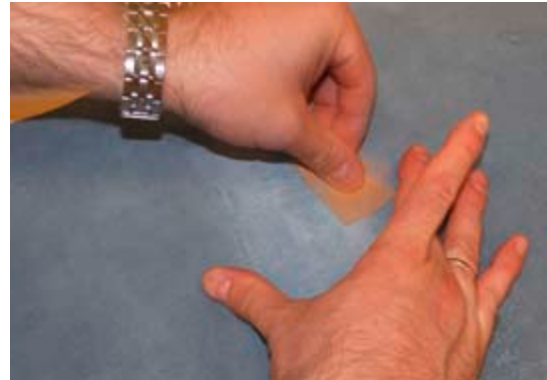
Abschmiegeln des Buchrückens mit Sandpapier zur Begradigung der ausgeschabten Oberfläche
