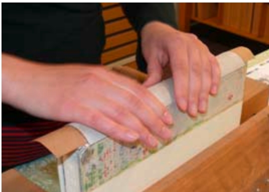
Anreiben der gerundeten Rückeneinlage an der Hülse
