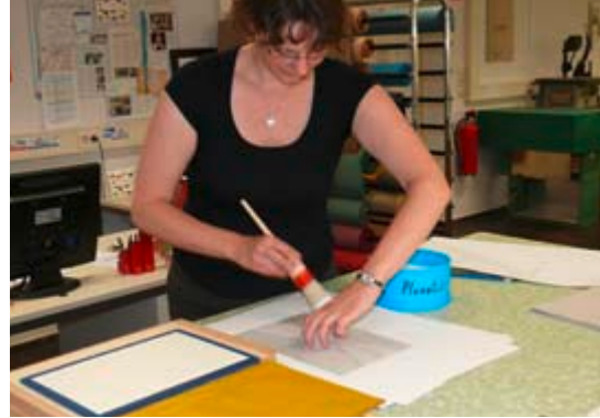
Anschmieren des vermaßten Kartons (Höhenausgleich zum Buchdeckelrand)
