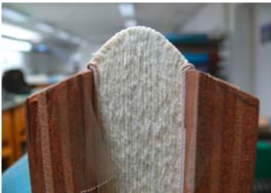
Fertig abgepresster Buchblock (spitze Form, da die Rundung noch etwas zurückgehen wird)
