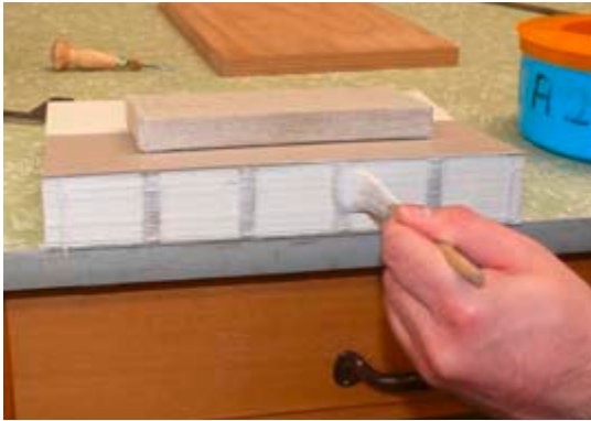
Ableimen des Rückens vom fadengehefteten Buchblock mit Kunstharz-Kleber
