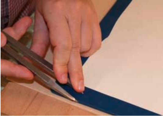
Anzeichnen des Leders mit dem Zirkel für die Vereinheitlichung der Randbreite
