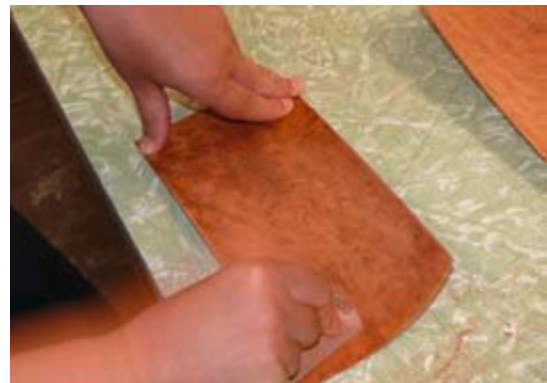
Abschmiegeln der Oberfläche des Kalbsleders für die spätere Herstellung erhabener Bünde
