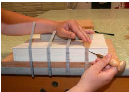
Einfädung und Begrädigung der aufgefächerten Kordel (Hanf)
