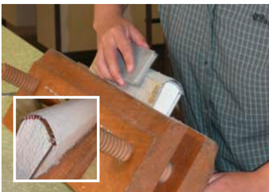
Selektives Abschleifen der Rückenpappe zur Beseitigung von Unebenheiten
