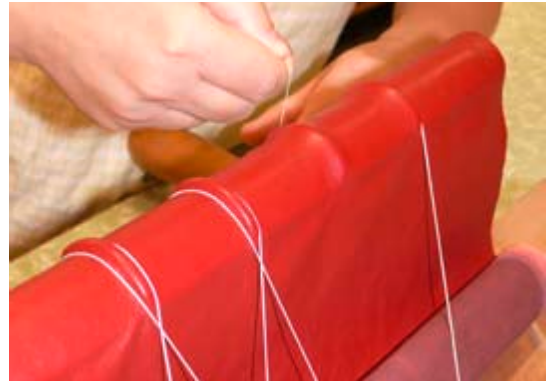
Vorformen der Bünde mit Hilfe von gespanntem Zwirn
