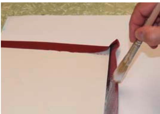
Anschmieren des Leders an den Vorderkanten
