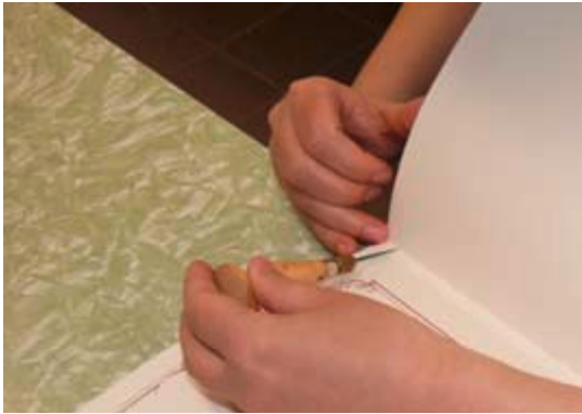
Vorstechen aller Falzbogen für die Fadenheftung
