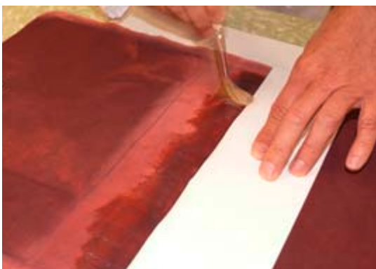
Anschmieren des Leders mit Kleister im Bereich des Bundes
