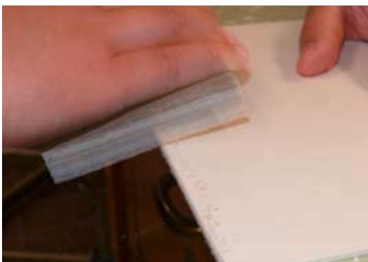
Anrunden der Außenkanten der Deckelpappen mit einem Schleifklotz
