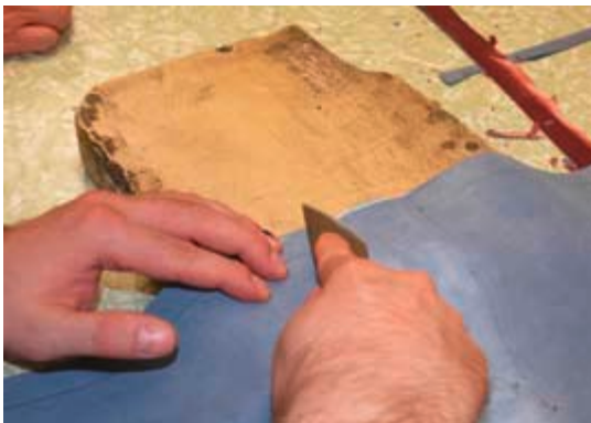
Schärfen des Leders an den Kanten zum Erzielen dünner Materialübergänge
