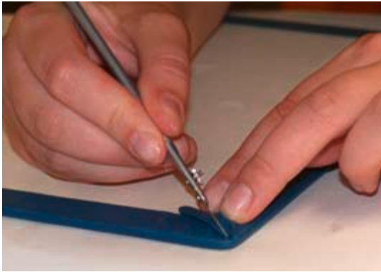
Einschneiden des Leders in einer Ecke unter Berücksichtigung des 45°-Gehrungswinkels
