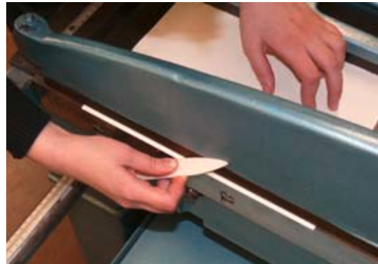
Vorfalzen der äußeren Falzbogen für spätere 90°-Abpressung („tiefer Falz“)
