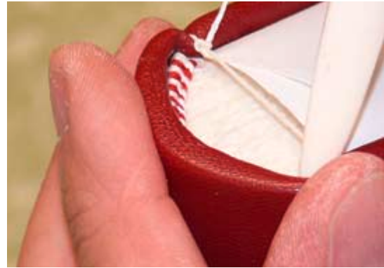
Abbinden des Falzes mit Zwirn und Formen des Häubchens mit dem Falzbein
