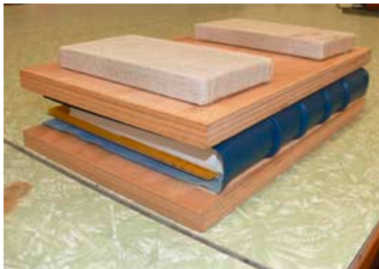
Beschweren des Ganzfranzbandes zum Trocknen
