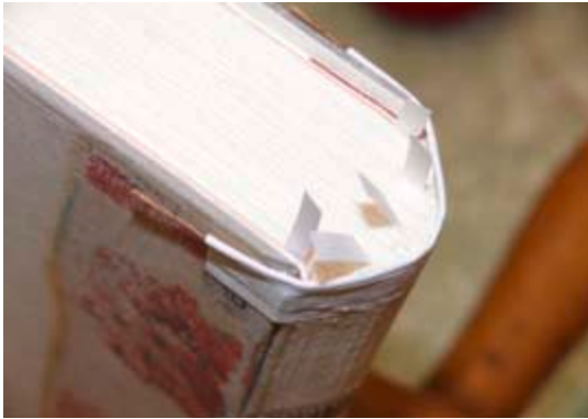
Buchblock mit Shirting und Markierungen für die tiefen Stiche
