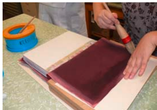
Anschmieren des Leders mit Kleister im Bereich der Buchdeckelpappe
