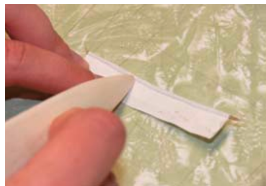
Herstellung der Basis für das Kapitalband (verleimter Hanffaden im Shirting)
