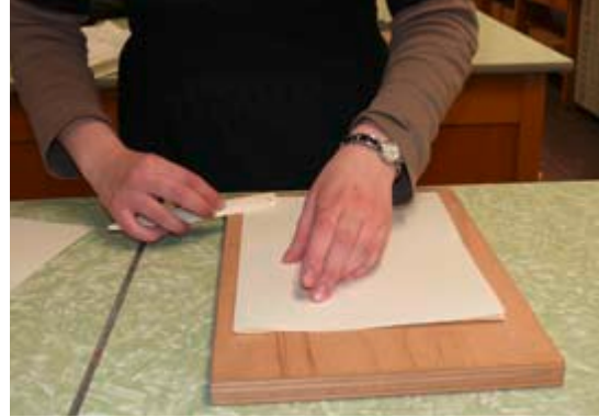
Falzen der Druckbogen (Einmittenfalz) mit dem Falzbein
