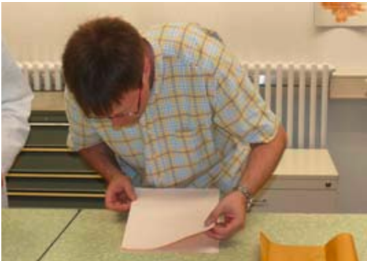
Gegenkaschieren der Spiegel
