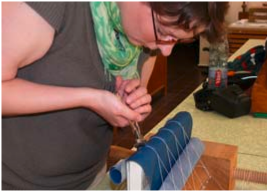
Formen der Bünde mit der Bündezange
