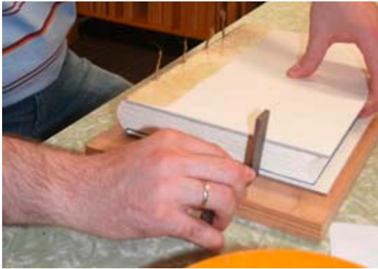
Prüfung der Standgenauigkeit und Winkligkeit der Deckelpappen zueinander
