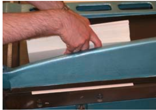
Schneiden des englischen Vorsatzes für Standgenauigkeit mit Buchblockbreite
