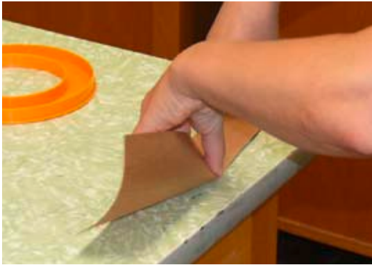
Falzen der Hülse, die Buchblock und Buchrücken miteinander verbindet
